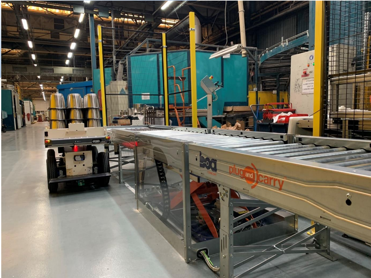
Plug-and-Carry® et Convey-LINK déployés sur le site d'un fournisseur de robots de cuisine
