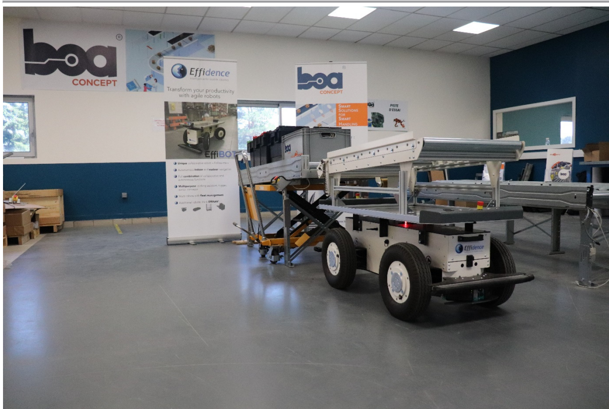
Le convoyeur modulaire intelligent Plug-and-Carry interfacé avec le robot EffiBOT
